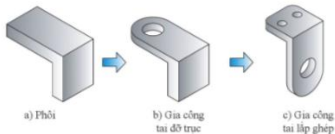
Hình 2.6. Trình tự gia công chi tiết giá đỡ trực
